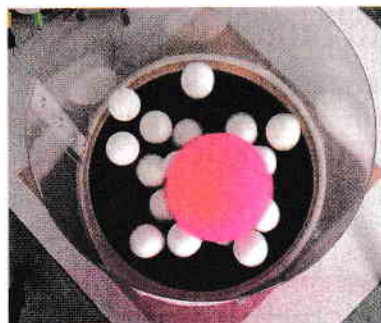
Fig. 3 - Dispozitiv pentru demonstrarea mișcării browniene
