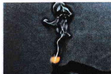
În imaginea Schlieren de mai sus se pot observa curenții de aer cald care se ridică de la flacăra unei brichete.
